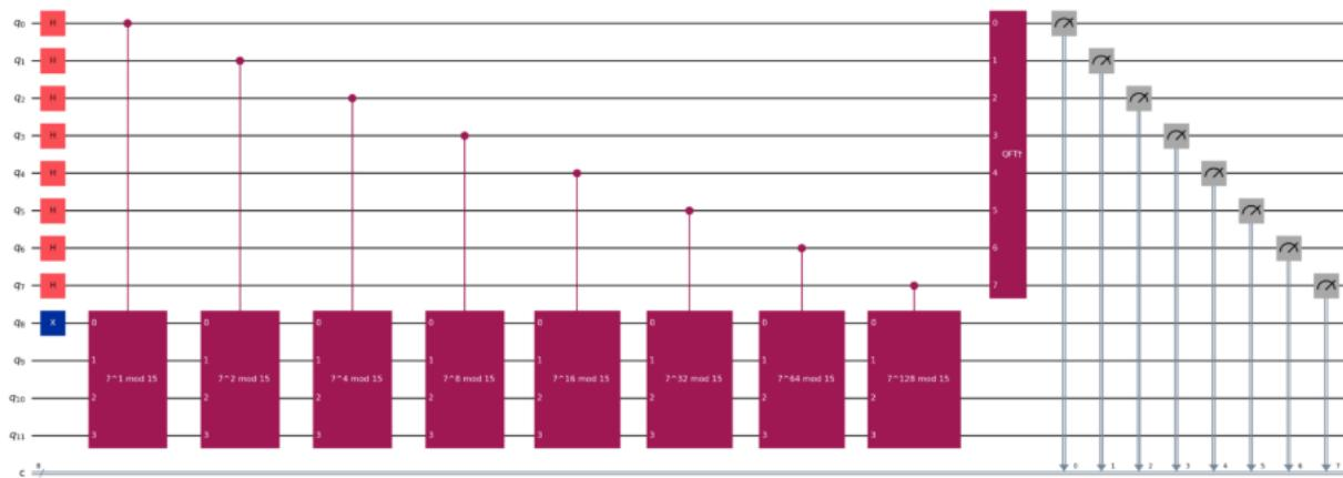
La figura mostra il circuito quantistico completo utilizzato per fattorizzare N=15. Si tratta di una sequenza di circa 75.000 operazioni quantistiche (gate) distribuite sui 12 qubit. Le linee orizzontali rappresentano i singoli qubit, mentre i simboli grafici lungo queste linee sono i gate quantistici che manipolano gli stati.
